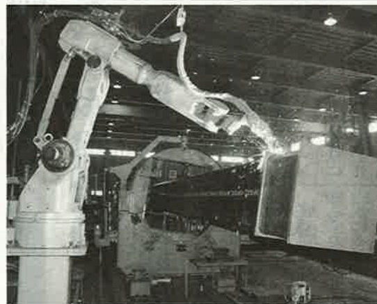
神戸製鋼所製の柱大組立溶接口ボットシステム(シングルアーク)による溶接施工のよう
